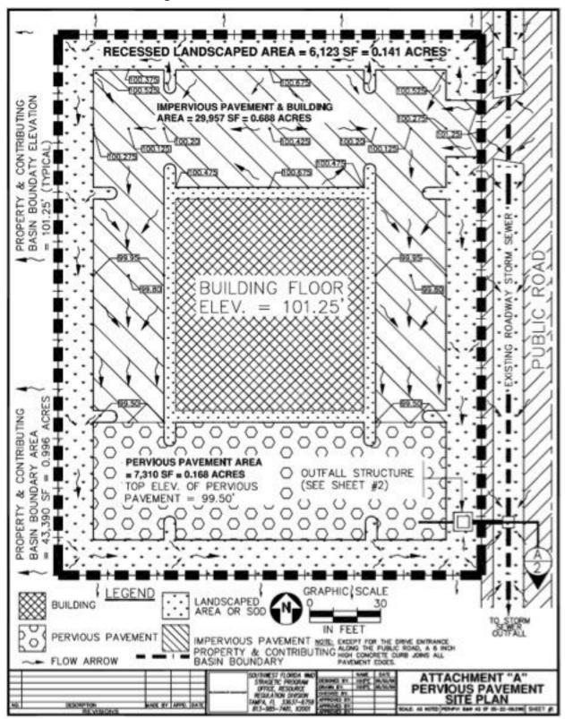
Figure 5.9.7. Pervious Pavement Site Plan
